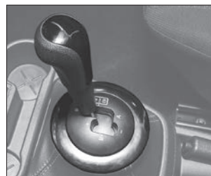
Рис. 36в. Рычаг переключения передач автоматизированной трансмиссии (АМТ)
