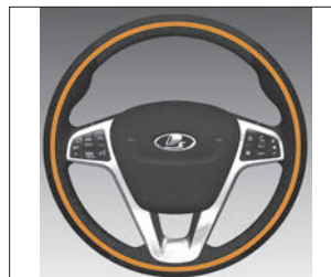
Рис. 3.4.6. Зоны обогрева рулевого колеса (в варианном исполнении)
