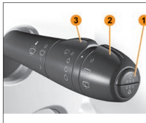
Рис. 3.9.7. Кольца и кнопки управления на правом рычаге подрулевого переключателя (в варианном исполнении)
