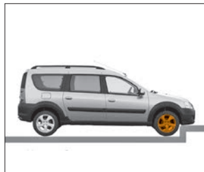
Рис. 2.6.6. Пример ситуации с возможным срабатыванием фронтальных подушек безопасности при ударе о бордюр, кромку тротуара или твердый материал
